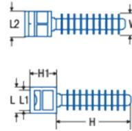
Стенной крепеж предназначен для крепления пучков проводов или кабелей при помощи кабельных хомутов к вертикальным поверхностям.
