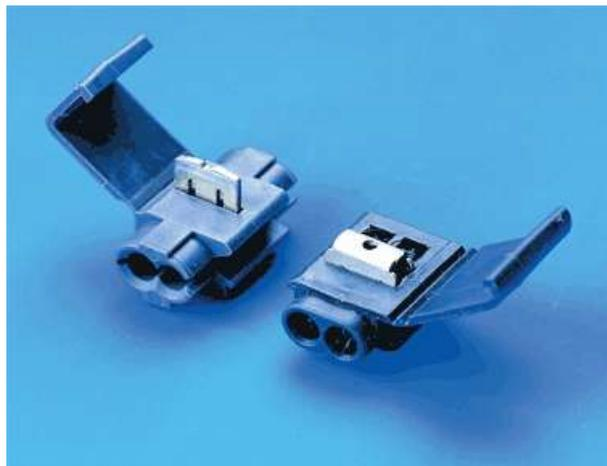
Электрические соединители Scotchlok™ с врезным контактом предназначены для соединения или присоединения силового провода (отвода) к магистральному проводу и изоляции соединения. Соединители рассчитаны на использование с медными силовыми кабелями/проводами, однопроволочными или многопроволочными, гибкими или жесткими. Сечение проводов – от 0,5 мм<sup>2</sup> до 4,0 мм<sup>2</sup>, максимальный диаметр изоляции – до 4,8 мм.
