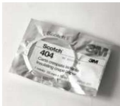
Лента из гофрированной бумаги с масляной пропиткой для высоковольтной изоляции, а также изоляции соединительных и концевых муфт на кабелях среднего напряжения. Благодаря гофрированной структуре обладает повышенным запасом масла.
