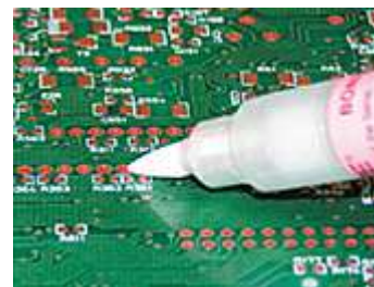
Селективная очистка печатного узла изопропиловым спиртом
