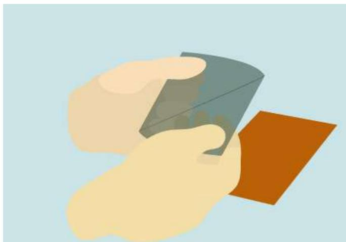
**3. с.** Фоторезист имеет 2 защитных слоя. Один, тонкий, со стороны, контактирующей с печатной платой (внутренняя сторона рулона), другой, более толстый, с внешней стороны рулона фоторезиста. Нужно отделить тонкий защитный слой. Это потребует определённых усилий и сноровки, поэтому следует запастись терпением.
