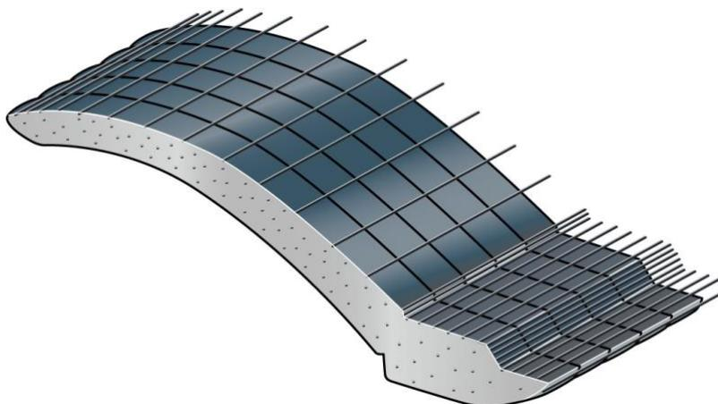
Кусачки, произведённые методом экструзии, имеют наклонную структуру кристаллической решётки. Поэтому, они наиболее подвержены поломке, в большей степени – вдоль режущих кромок и соединения
