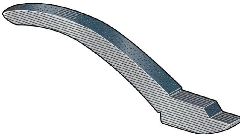
Штампованный инструмент имеет прямую кристаллическую решётку. Такая конструкция приемлема для определённых видов работ, но долговечность и прочность являются компромиссом между ценой и надёжностью
