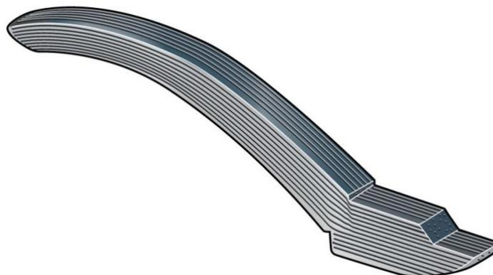
Кованые кусачки обычно наиболее прочны. Структура их кристаллической решётки повторяет контур кусачек
